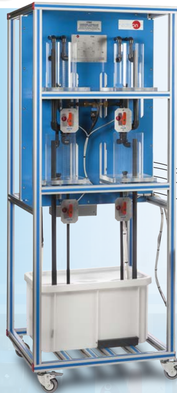
CTAC Sistema de Tanques Acoplados , Controlado desde Computador (PC)
