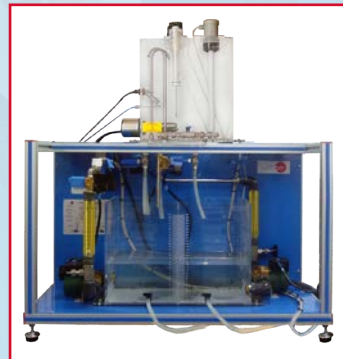
UCP Sistema de Control de Procesos (con válvula de control electrónica ), Controlado desde Computador (PC)
